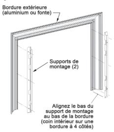
Note: Il est possible que la bordure nécessite une extension pour couvrir l'ouverture de l'âtre jusqu'au mur combustible. Des pièces de métal taillées sur mesure peuvent être ajoutées à la bordure en les fixant à la rainure de vis située à l'arrière de la bordure.
